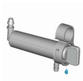
1015-04 dryp med luge til inspektion, med filter og bagudvendt dryp. Ydelse 4 l/t. Hul til montage Ø 3,6 mm
